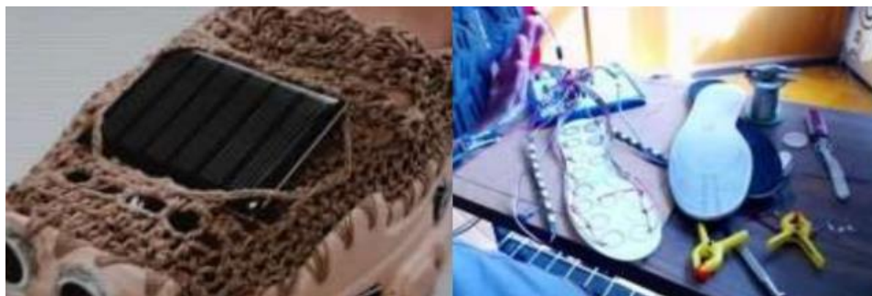
شکل ۱: صفحات پیزو الکتریک در کفش شکل ۲: سلول متصل به کفش
