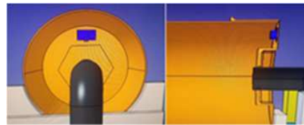
شکل ۱۲: محل قرارگیری سنسور در مخزن
