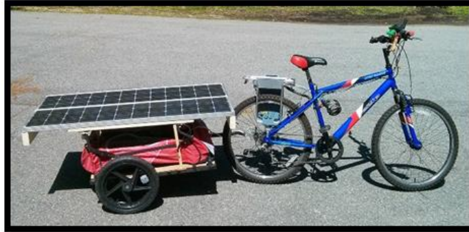
شکل ۵. دوچرخه خورشیدی با مشخصات 12V/50W
