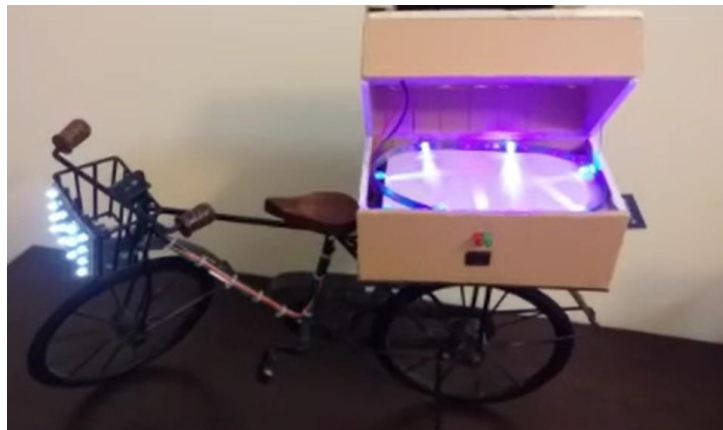
شکل ۷. ساخت ماکت دوچرخه خورشیدی هوشمند با جعبه استریل نصب شده روی دوچرخه
